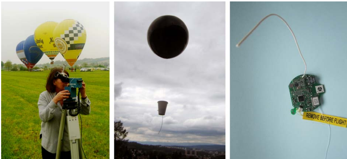
Fig. 2: Messung mit Windreader (links) und Windsond (mitte) mit hoch integrierter Elektronik (rechts)
